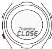
Dolg pritisk na tipko TOGGLE (-). Računalnik preide v mirovalni način. Prikazujeta se le ura in datum ob varčni porabi baterije. Aktualni podatki o treningu ostanejo shranjeni.
