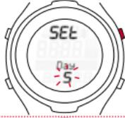
Pritisnite tipko START/STOP. Prikazuje se format datuma. S tipko TOGGLE (-) ali TOGGLE (+) lahko izberete želen format datuma.
