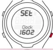
Pritisnite tipko TOGGLE (+). Prišteje se ena ura. S tipko TOGGLE (-) bi se na prikazu ena ura odštela.
